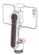
Mode de verrouillage (L): Appuyez une fois sur le bouton M pour activer ce mode. Ce mode verrouille le mouvement des deux axes et l'orientation du smartphone est fixe. Poussez le joystick vers le haut/bas pour contrôler l'axe de roulis manuellement, et poussez vers la qauche/droite pour contrôler l'axe de panoramique manuellement.
